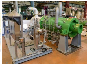
Fig.33 Mix-Refrigerant LNG Integrated Compression 8MW - 5.6kV - 9400rpm
